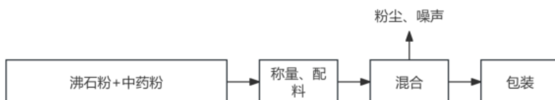
图 3.1-6 底改产品工艺流程图
