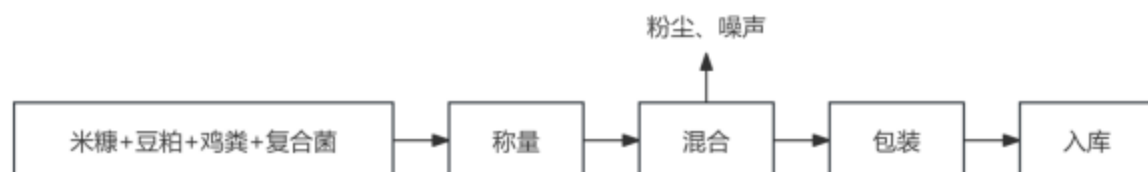
图 3.1-3 水质改良产品粉剂（利生素）工艺流程图
